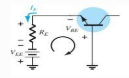
Determining V<sub>CB</sub> & V<sub>CE</sub>
